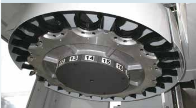
★ Инструментальный магазин ММ 400/430 на 16 позиций (стандартная комплектация)
