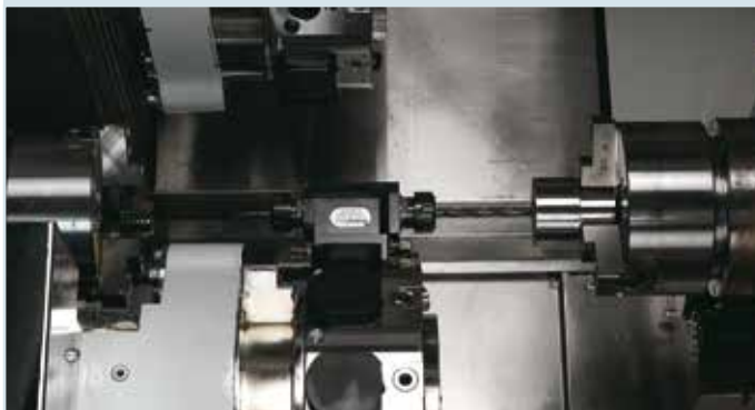
★ Две револьверные головки / два шпинделя (стандартная комплектация)
