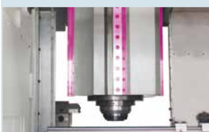
★ Три роликовых направляющих по оси Z (запатентовано)
