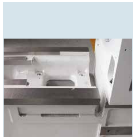
★ Выемка в станине для обработки крупногабарит- ных деталей типа «диск»
